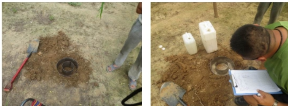
图 5-16 渗水试验现场
